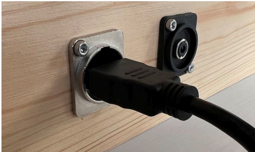
Debemos conectar el cable HDMI tanto al proyector como al conector lateral del Sonògraf
